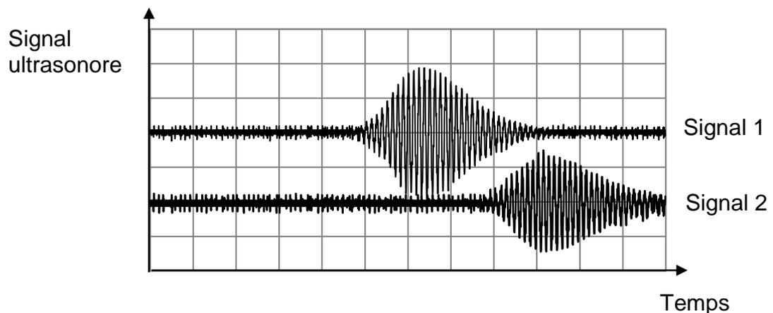
Document 3 – Tension mesurée (en V) en fonction du temps (en  $\mu\text{s}$ ) pour un émetteur ultrasons et pour un récepteur ultrasons indépendants. La sensibilité verticale pour les deux voies est de 1 V/div. La sensibilité horizontale pour les deux voies est de 200  $\mu\text{s}/\text{div}$ .
