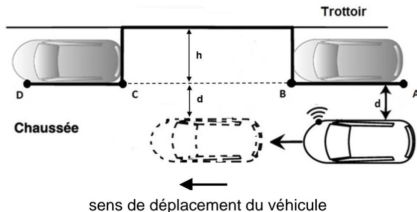
Document 5 – Schéma de principe du stationnement automatique
